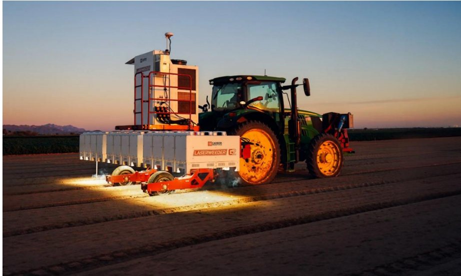
Slika 8: Laserski uništavač korova Carbon Robotics LasserWeeder G2
